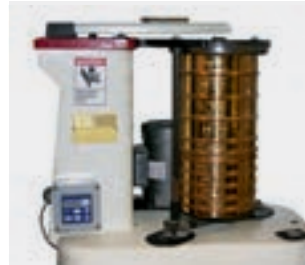
Silageanalyse mit Ro-Tap Shaker von Dairyland Laboratories, Inc.
