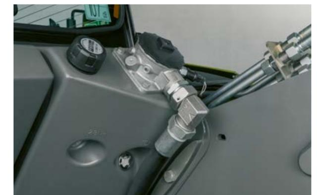
Der Hydraulikölstand lässt sich über ein Schauglas bequem kontrollieren. Die Hydraulikanlage ist durch einen Rücklaufilter geschützt. Den Filter wechseln Sie erst nach 1.000 Betriebsstunden.
