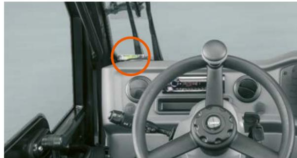
Wasserwaage in der Kabine
