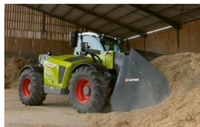
Automatische Schaufelrückführung für schnelleres Arbeiten in Bodennähe
