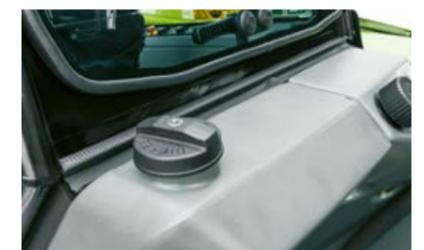
Abschließbarer Kraftstofftank hinter der Kabine
